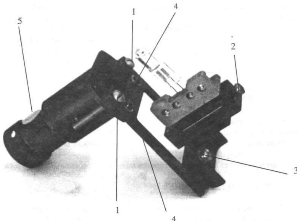
Рисунок 7 - Узел осветителя с механизмом перемещения лампы
