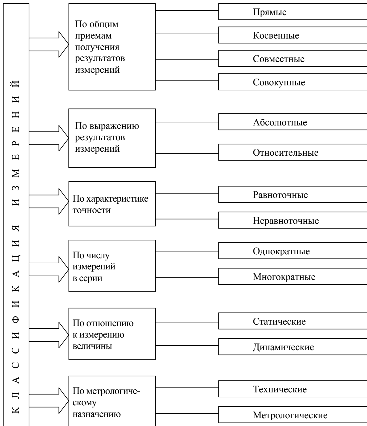
Рис. 1.4. Блок-схема классификации измерений
